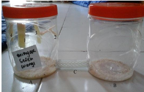
5.7 Pengujian minyak serai wangi (A) wadah dengan minyak atsiri serai wangi. (B) wadah tanpa minyak atsiri. (C) selang penghubung.
