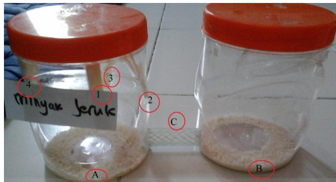
Gambar 15. Wadah uji aktivitas minyak atsiri terhadap kutu beras. Keterangan: A = Wadah berisi beras + kutu beras + kertas saring whattman no.1 yang telah ditetesi minyak atsiri. B = Wadah berisi beras. C = Selang penghubung. 1, 2, 3, 4 = Titik-titik pemberian minyak atsiri.
