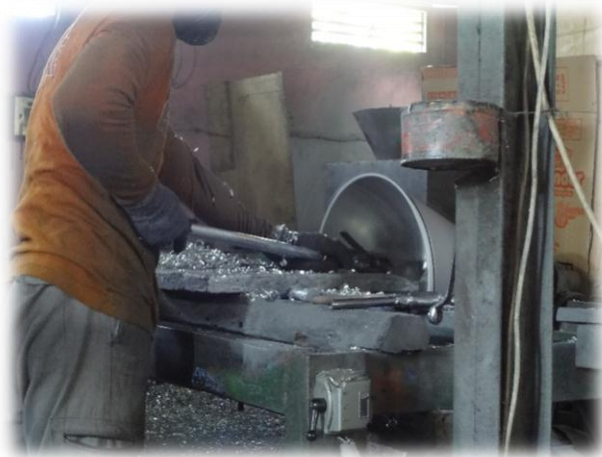
Gambar 4.7 Membubut Benda Hasil Coran
