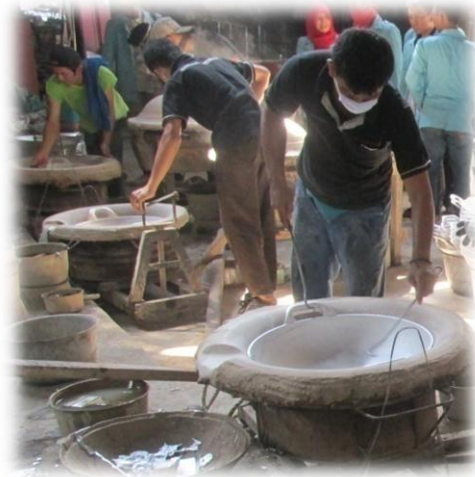
Gambar 4.6 Mengangkat Hasil Coran
