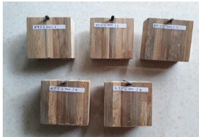
Gambar 5.23 Uji Tumpu Sekrup Fine Thread Drywall (FTD)
