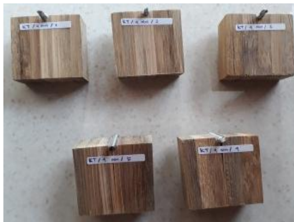
Gambar 5.29 Uji Tumpu Sekrup Sheet Metal
