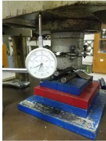
Gambar 4.12 Set Up Uji Kuat Lentur
