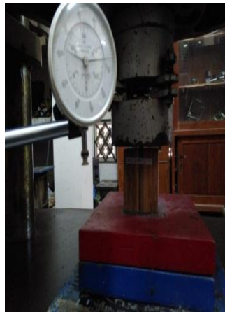
Gambar 4.13 Set Up Uji Kuat Tumpu
