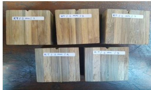
Gambar 4.1 Benda Uji Kuat Tumpu
