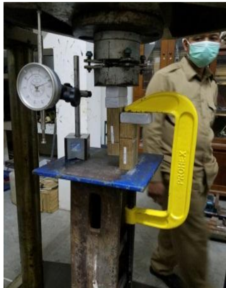
Gambar 4.11 Set Up Uji Kuat Sambungan
