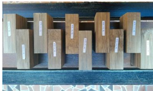
Gambar 4.2 Benda Uji Kuat Sambungan
