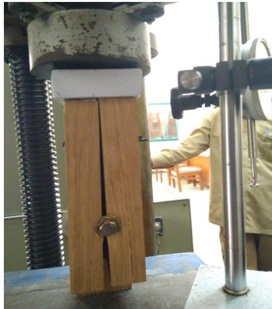
Gambar L-4.4. Kerusakan Benda Uji
