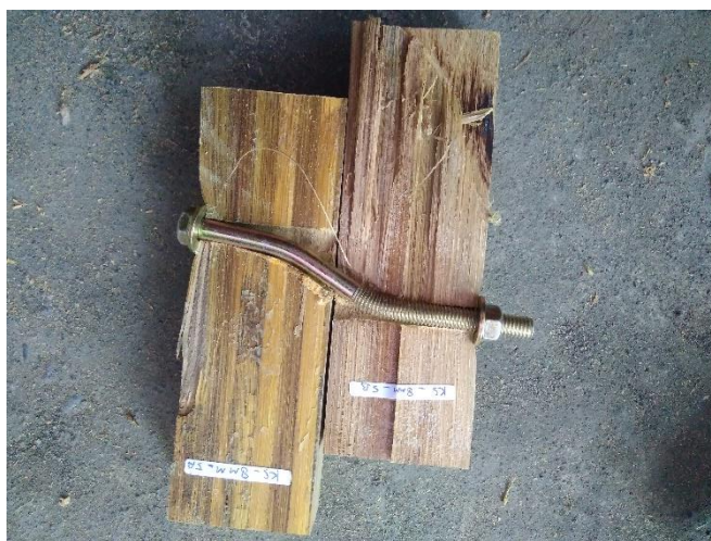
Gambar 5.29 Mode Kegagalan IV pada Sambungan Bambu Dengan Ring
