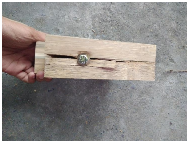
Gambar 5.28 Kerusakan Pada Sambungan Bambu Dengan Ring
