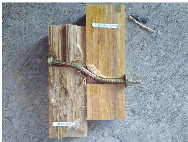
Gambar 5.27 Mode Kegagalan IV Pada Sambungan Bambu Tanpa Ring
