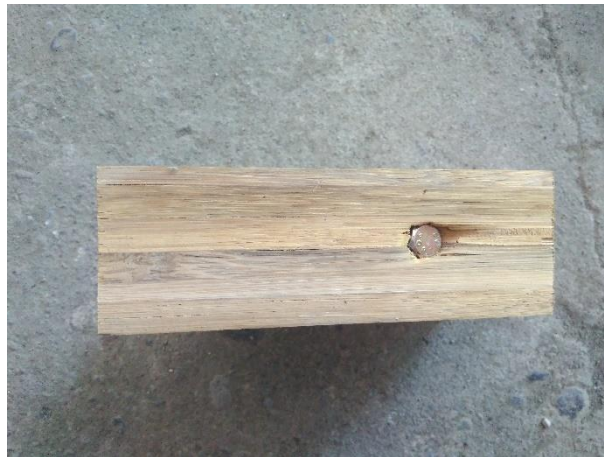
Gambar 5.26 Kerusakan Pada Sambungan Bambu Tanpa Ring
