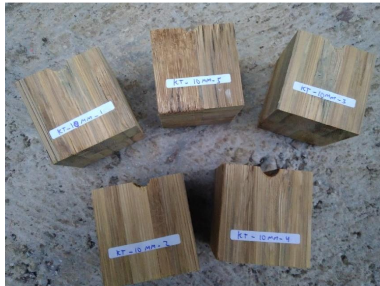
Gambar 4.12 Benda Uji Pengujian Kuat Tumpu Bambu Laminasi
