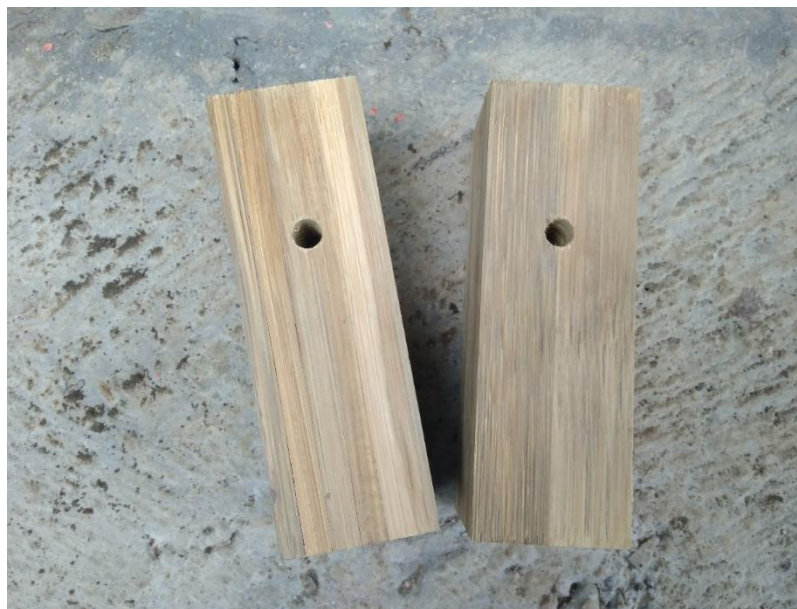
Gambar 4.14 Balok Bambu Laminasi yang Telah Dilubangi
