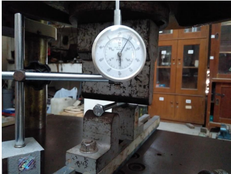
Gambar 4.11 Tampak Depan Pengujian Lentur Baut
