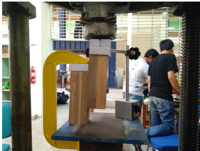
Gambar 4.16 Penempatan Benda Uji Pada Mesin UTM
