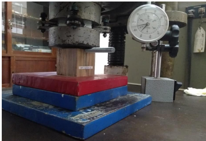
Gambar 4.13 Proses Pengujian Kuat Tumpu Bambu Laminasi
