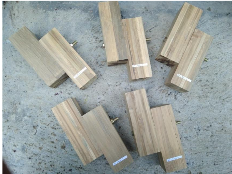
Gambar 4.15 Balok Bambu Laminasi yang Telah Disambung dengan Baut
