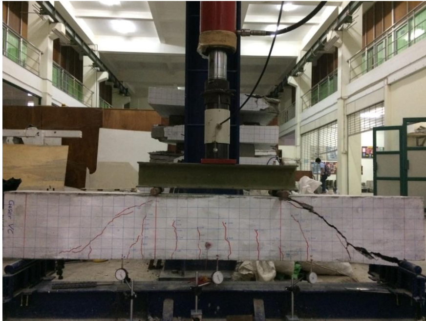
Gambar 5.39 Benda Uji G-HSC Tampak Depan
