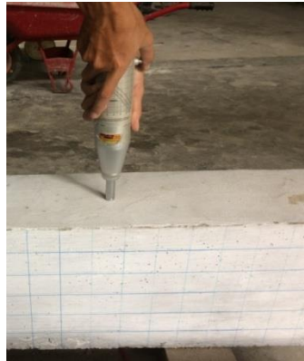
Gambar 5.2 Pengujian Hammer Test pada Balok Benda Uji
