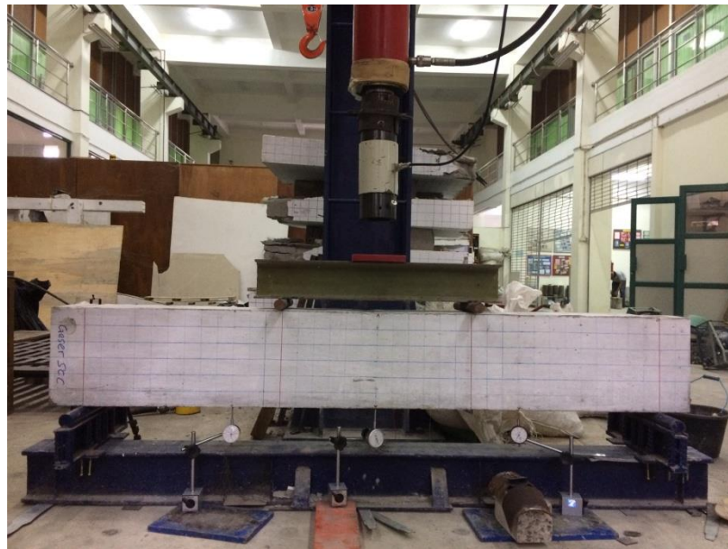
Gambar 5.6 Model Pembebanan Benda Uji Eksperimental
