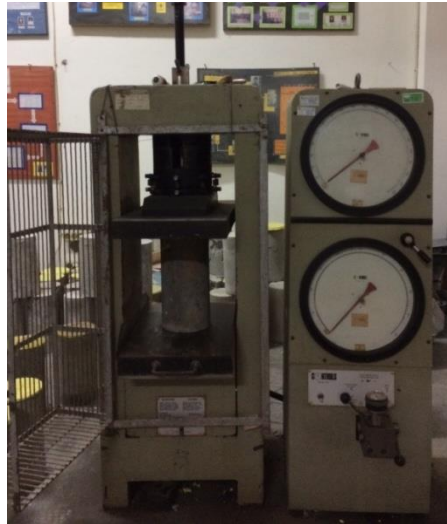
Gambar 5.1 Uji Kuat Tekan Beton
