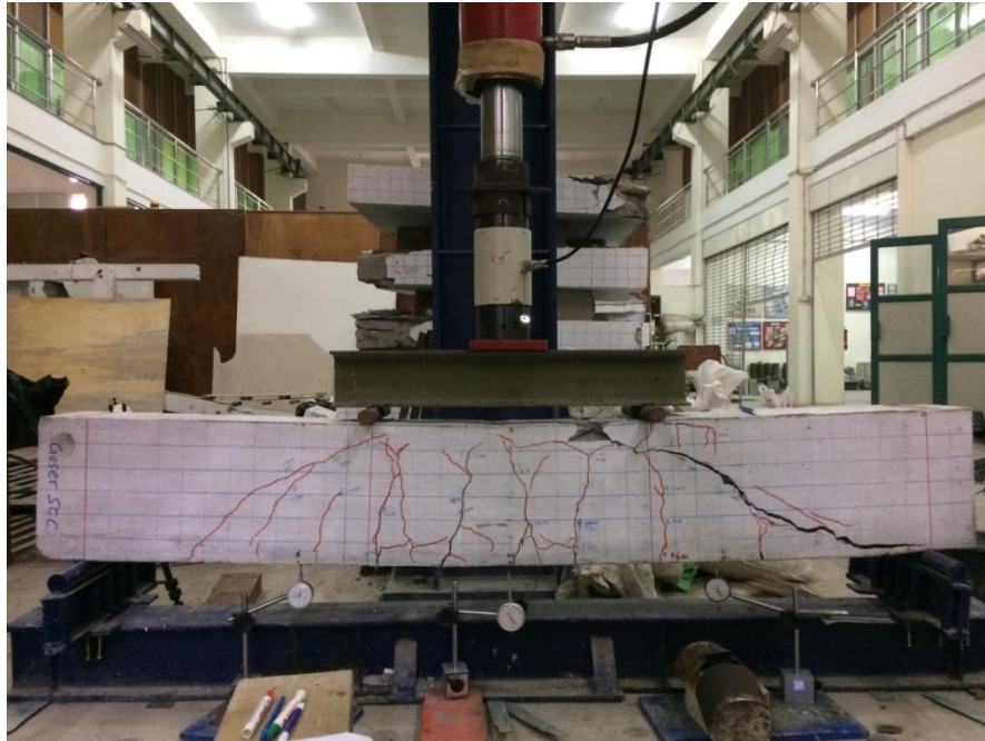
Gambar 5.36 Benda Uji G-SCC Tampak Depan
