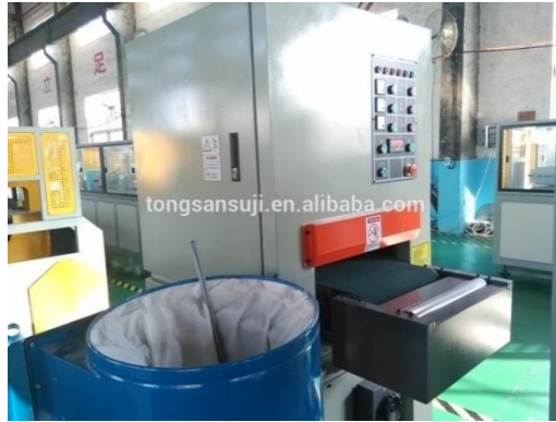
Gambar 3.6. Mesin Sander Sumber : alibaba.com
