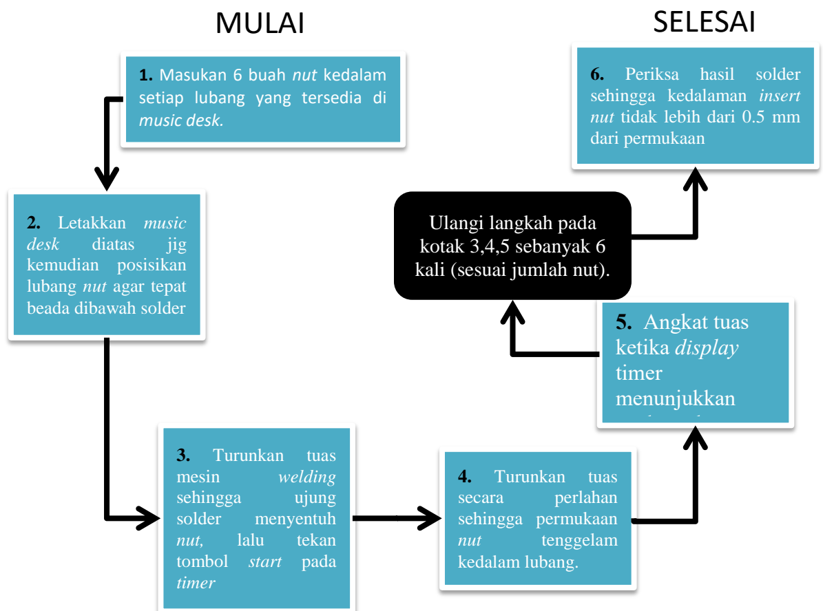
Gambar 3-10 langkah kerja proses merekatkan nut (before)
