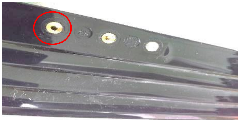
Gambar 4-6 tucak pada music desk saat uji coba mesin insert nut (after)
