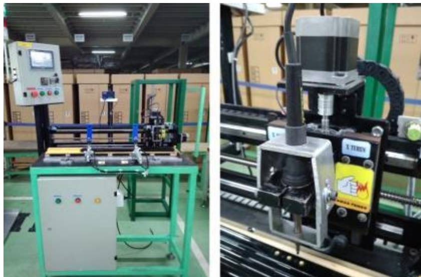
Gambar 4-2 mesin insert nut yang telah difabrikasi
