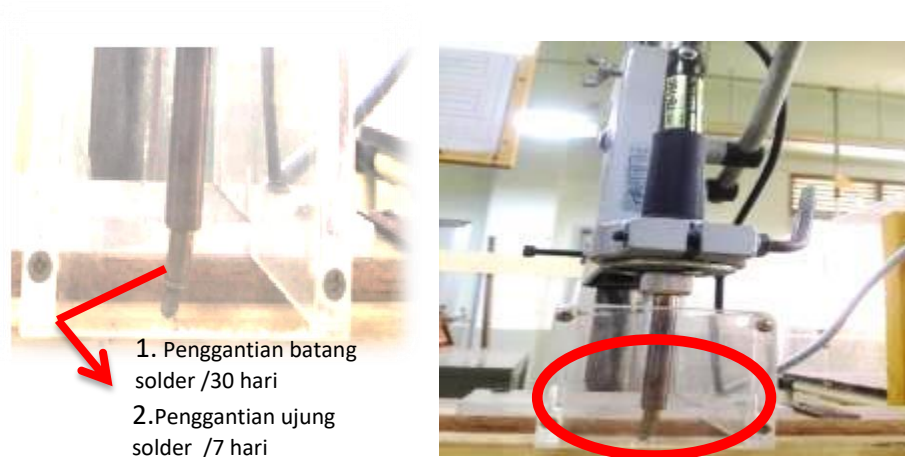
Gambar 1-1 permasalahan pada mesin insert nut
