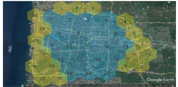
Gambar 6. Pemetaan peletakan e-Node B untuk daerah urban dan sub-urban .
