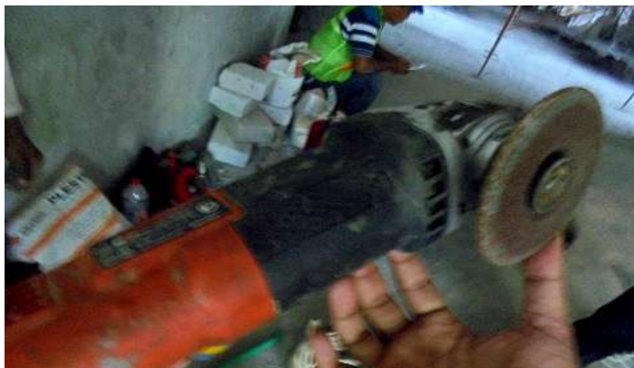
Gambar 5.28 Grinder Tanpa Penutup Sumber: Dokumen Pribadi, 2018
