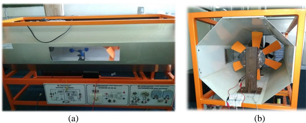
Gambar 2.2 Trainer Kit Turbin Angin; (a). Tampak luar; (b). Tampak dalam.
