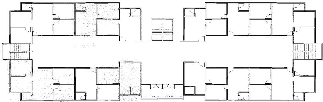
Denah Rusunawa Pekunden Lantai 1 Konfigurasi tipe 27 & 54
