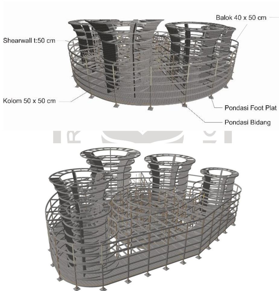
Gambar 5.81. Skema Struktur Utama Mall
