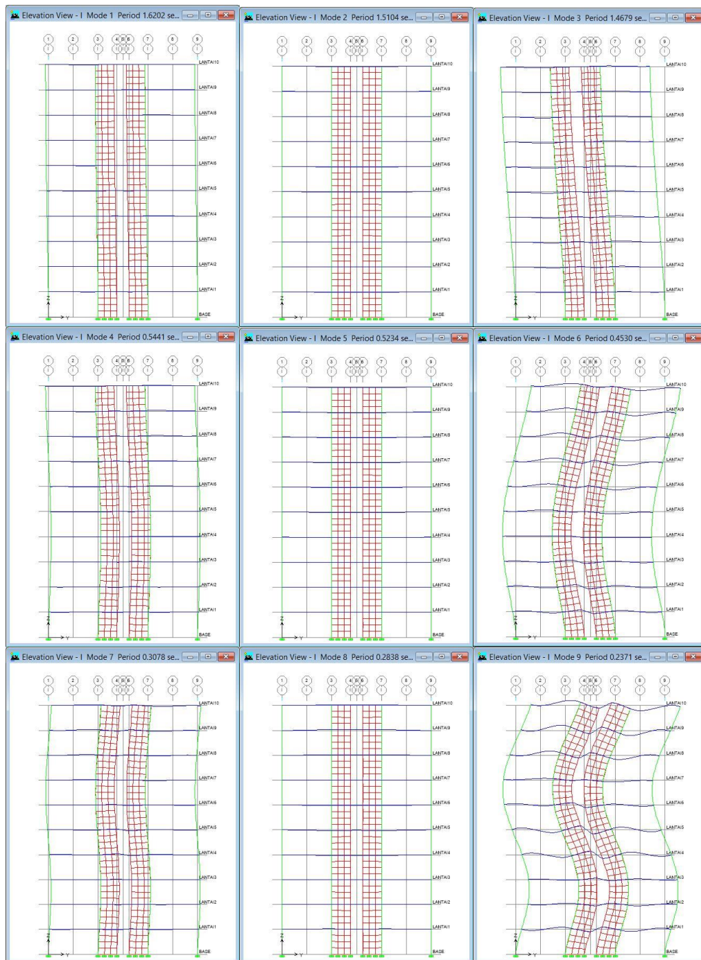
Gambar 5.38 Pola Goyangan Struktur Shearwall Model 3
