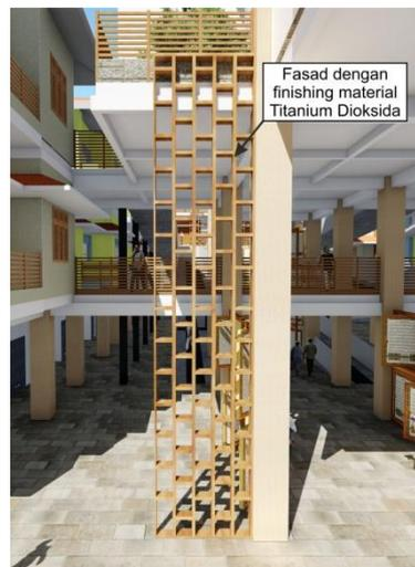
Gambar 4.14 : Fasad Kampung Vertikal dengan Material Titanium Dioksida sebagai *Finishing*
