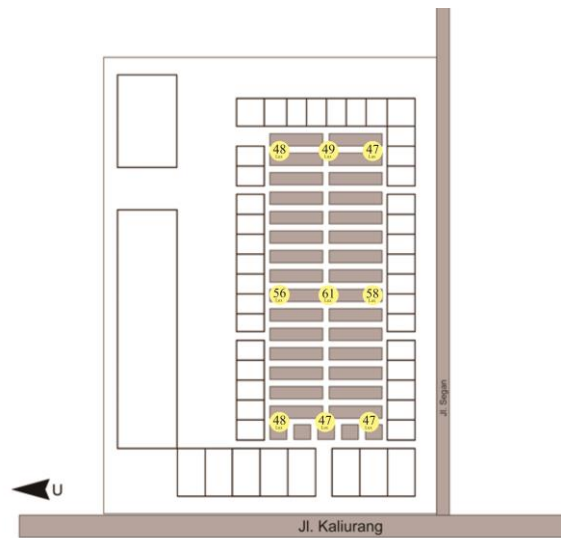
Gambar 2. 17 Data intensitas di dalam pasar menggunakan light meter Sumber: Penulis, 2018
