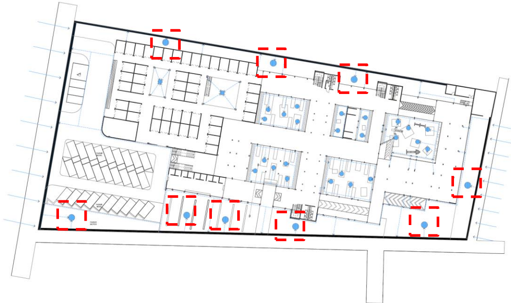
Gambar 5. 3 Area resapan air hujan pada area luar bangunan
