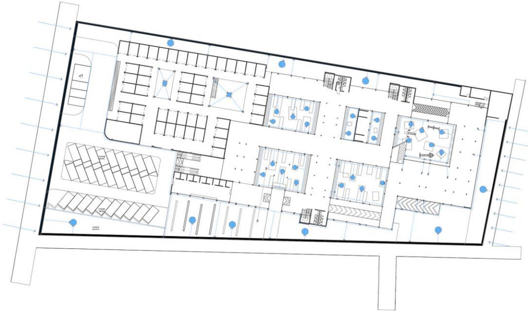
**Gambar 4. 8** Skema drainase air hujan pada tapak
