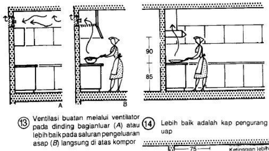
Gambar 2.28 : Ventilasi Untuk Menyalurkan Asap
