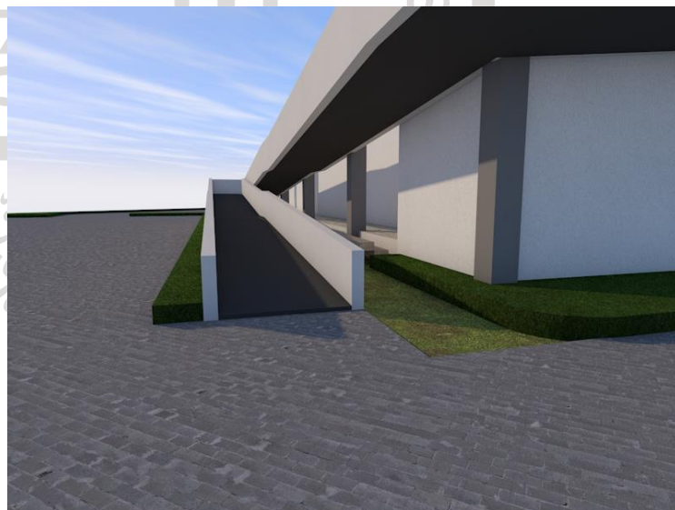
Rancangan Skematik Ramp Pada Bangunan
