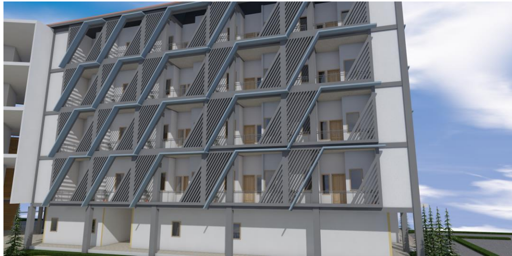
Skematik Selubung Bangunan Pada Hunian
