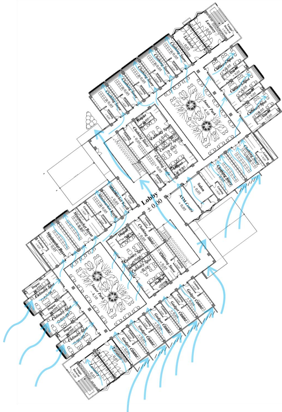
Gambar 107: Skema pergerakan angin di dalam bangunan terancang (Sumber: Penyusun, 2018)
