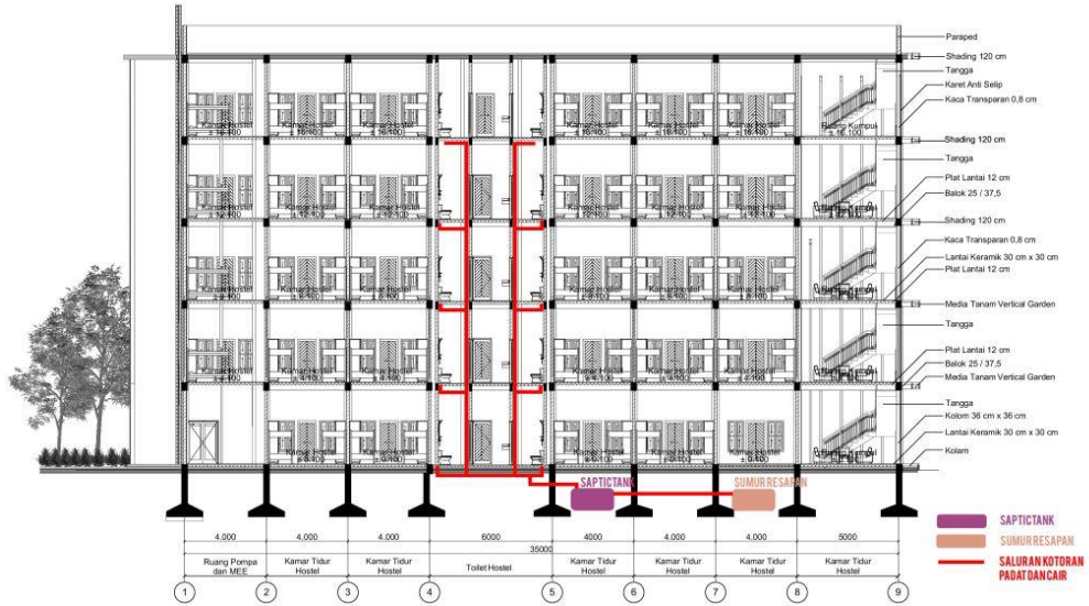
Gambar 6 . 33 Skema utilitas Air Kotor pada hostel di Waduk Taman Tirta Arta
