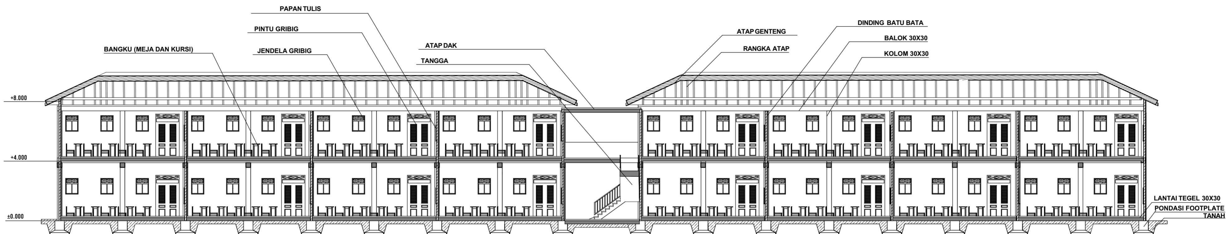
POTONGAN A-A RUANG KELAS PONDOK PESANTREN AL-ISHLAH TAJUG
