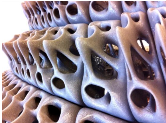
Gambar 5-2 3D Printing Polimer Beton yang Terdiri dari Modul yang Berbeda (Sumber: Ronald and Virginia, 2011)
