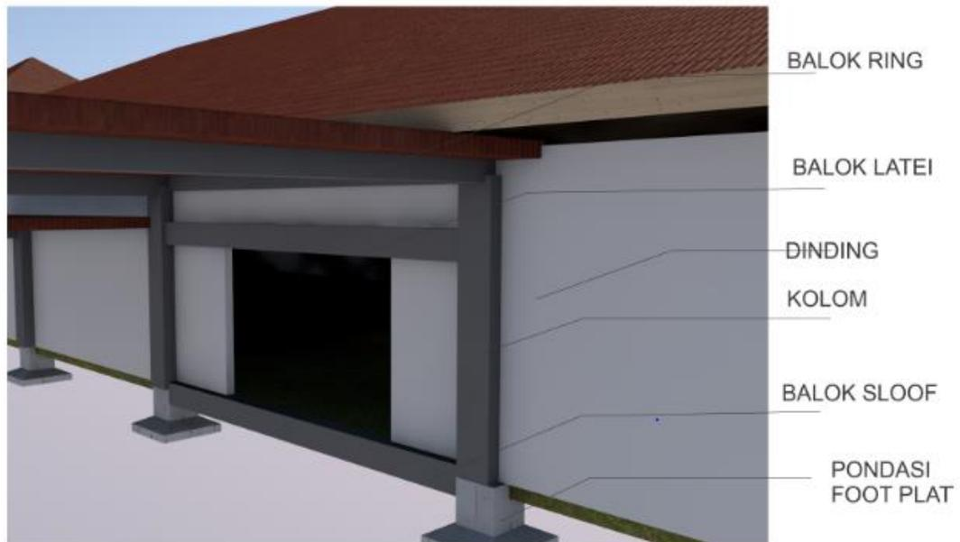
**Gambar 5.6** Skema Struktur
