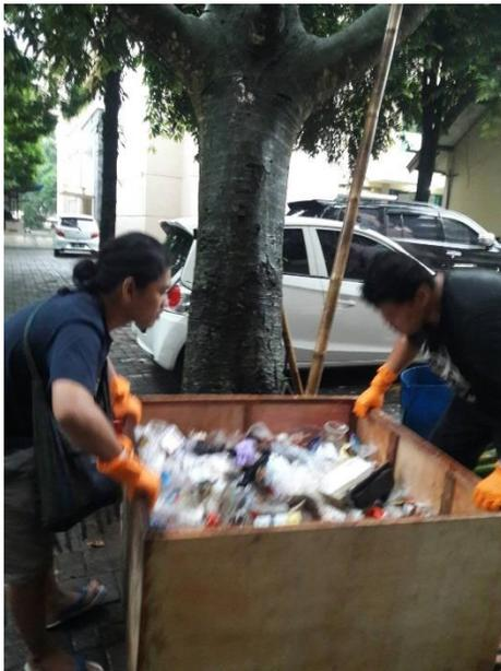
Proses pengukuran volume dengan kotak sampling yang berukuran 100 cm x 100 cm x 50 cm. Pada kotak sampling ini sampah yang dihasilkan pada hari itu dimasukkan ke dalam kotak sampling kemudian dipadatkan dan kemudian diukur volumenya sehingga didapatkan timbulan volume pada hari itu.
