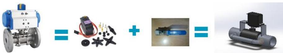
Gambar 5. 2 substitusi pneumatic valve dengan valve manual dan motor servo
