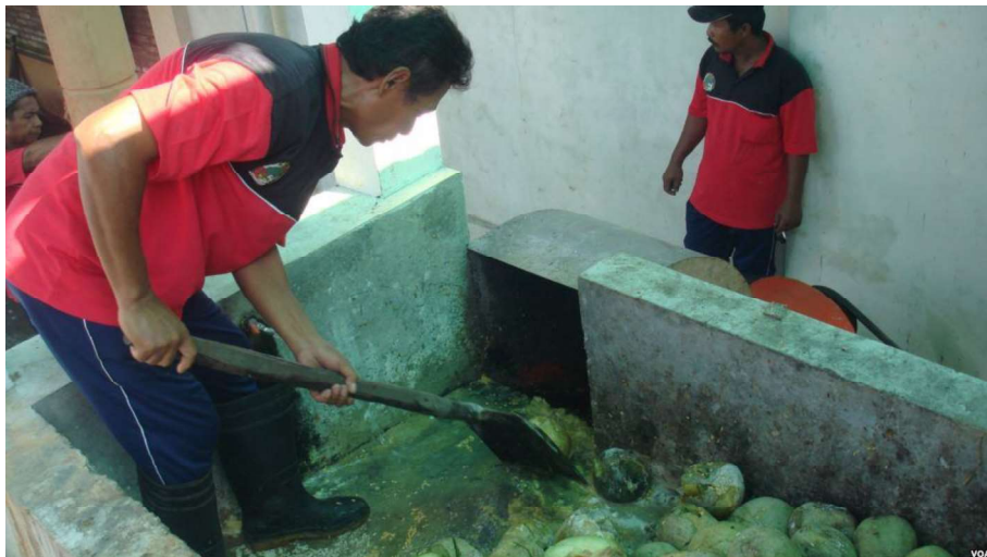
Gambar 53 Proses penggilingan buah busuk menjadi bahan utama biodigester
