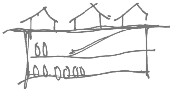
Parkir Komunal di Basement
