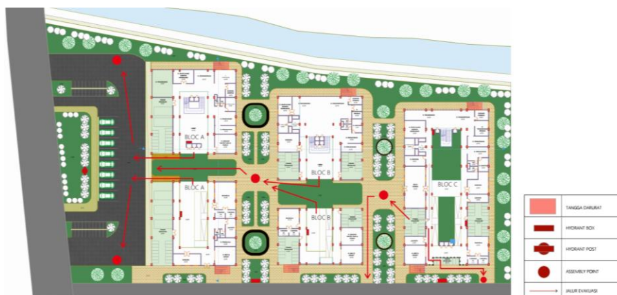
Gambar 5.27 Skema Keselamatan dan Penanggulangan Kebakaran
