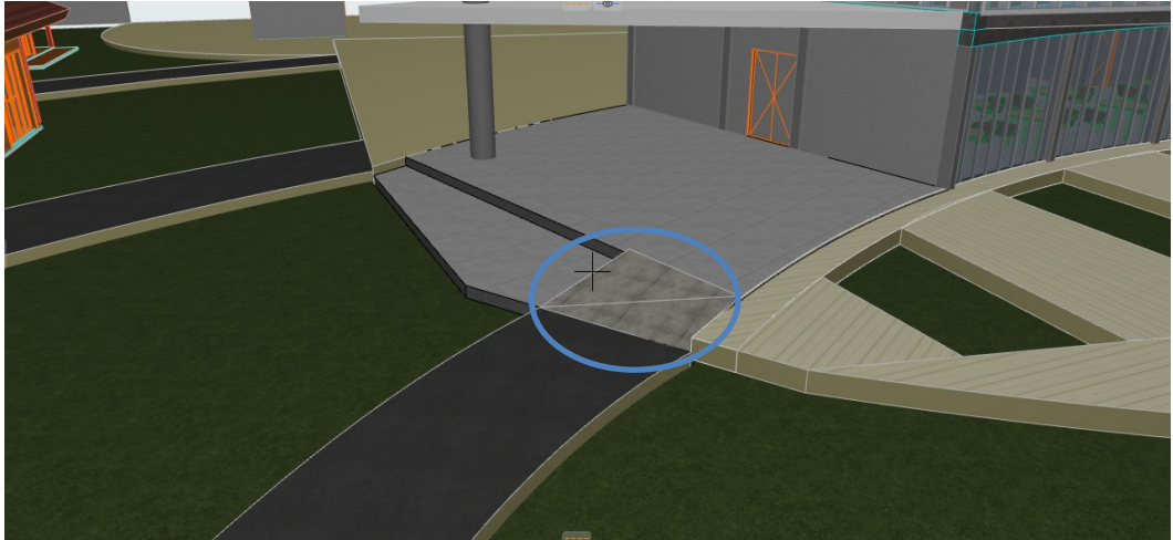
Gambar.4.26 Ramp difable menuju bangunan restoran
