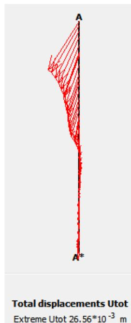
**Gambar 5.40 Potongan A-A' *Total Displacement Sheet Pile* Kondisi Muka Air Banjir dengan Beban Luar**
