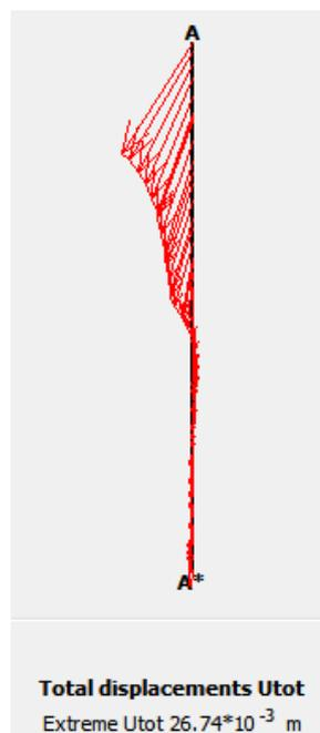
**Gambar 5.36 Potongan A-A' *Total Displacement Sheet Pile* Kondisi Muka Air Normal dengan Beban Luar**
