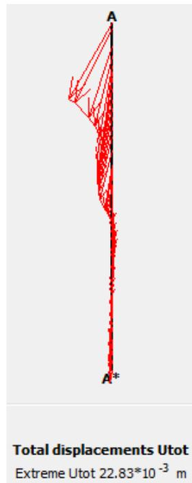
**Gambar 5.56 Potongan A-A' Total Displacement Sheet Pile dengan Angkur Kondisi Muka Air Banjir dengan Beban Luar**
