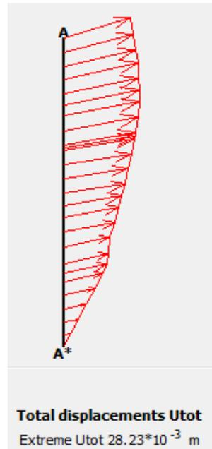
**Gambar 5.28 Potongan A-A' Total Displacement Dinding Penahan Tanah Kondisi Muka Air Normal dengan Beban Gempa**
