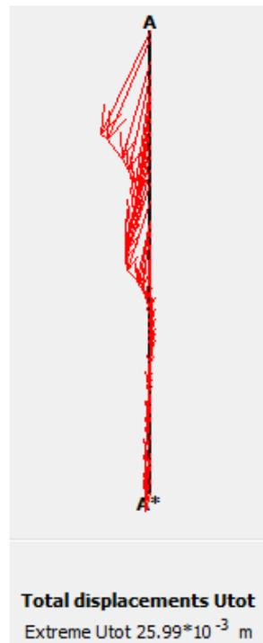
**Gambar 5.52 Potongan A-A' Total Displacement Sheet Pile dengan Angkur Kondisi Muka Air Normal dengan Beban Luar**
