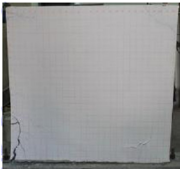
Gambar 5.22 Gambar Pola Kerusakan Eksperimen Dinding Frame
