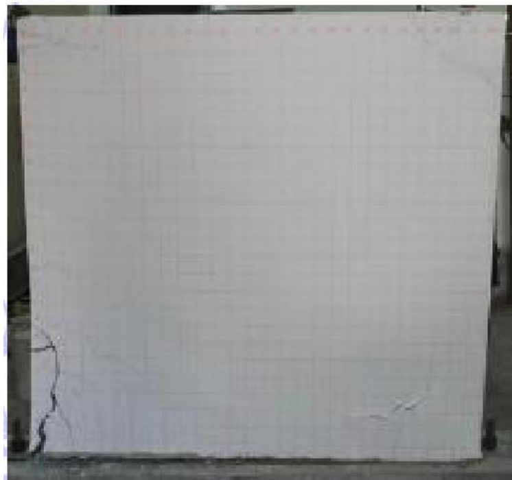
Gambar 5.112 Gambar Pola Kerusakan Eksperimen RC Frame Infill Masonry
