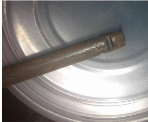
Gambar 4-9 Hasil pemotongan menggunakan alat potong kawat kedua dengan penambahan quick exhaust
