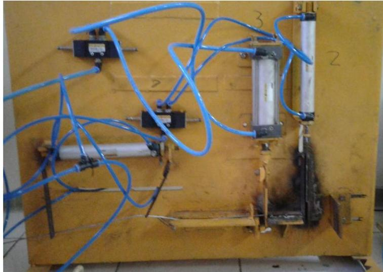
Gambar 3-6 Alat pembuat sengkang dengan menggunakan pneumatik (Hafidz Al Asad, 2016)
