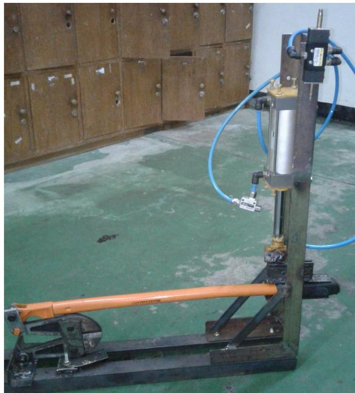
Gambar 4-8 Hasil pembuatan alat potong kawat kedua dengan penambahan quick exhaust
