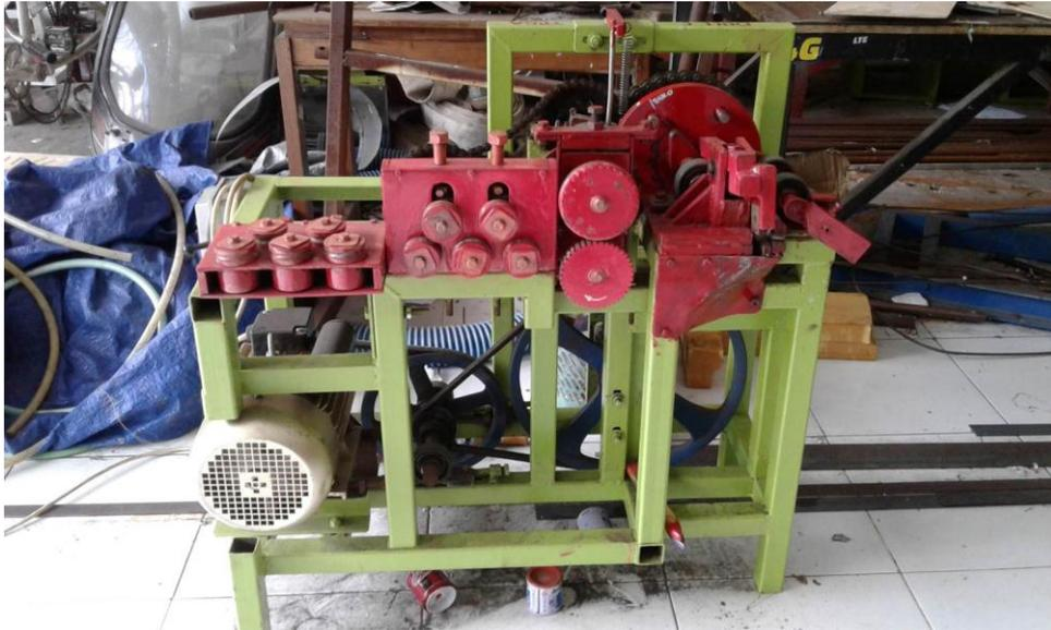
Gambar 3-4 Alat pembuat sengkang dengan menggunakan motor listrik (Doli Cania, 2017)
