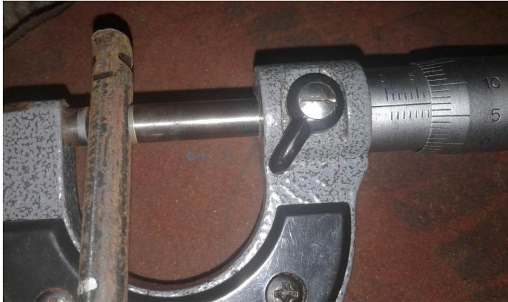
Gambar 4-5 Kawat dengan diameter 6 mm
