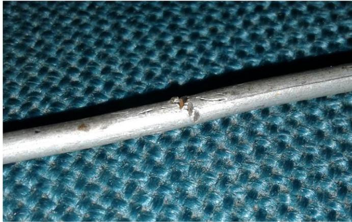
Gambar 3-8 Hasil pemotongan kawat sengkang belum berhasil
