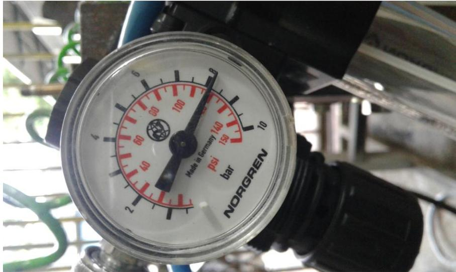
Gambar 3-22 Regulator yang digunakan pada alat pemotong kawat
