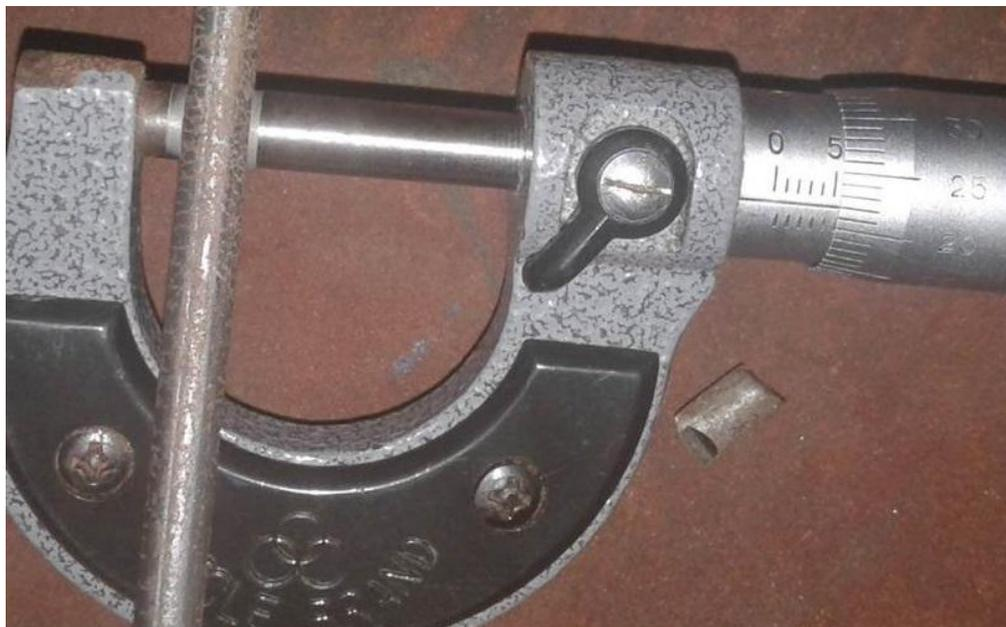
Gambar 4-4 Kawat dengan diameter 5 mm
