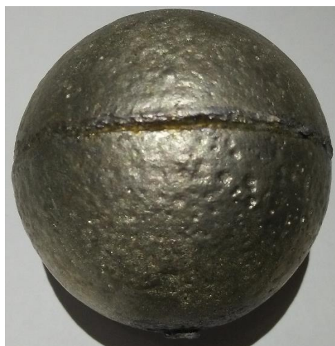
Gambar 4-28 Hasil jig 2 tanpa bagian atas temperatur 280° C
