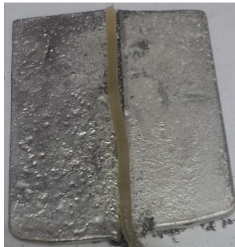
Gambar 3-7 Pemberian fluks rosin pada serbuk tenol
