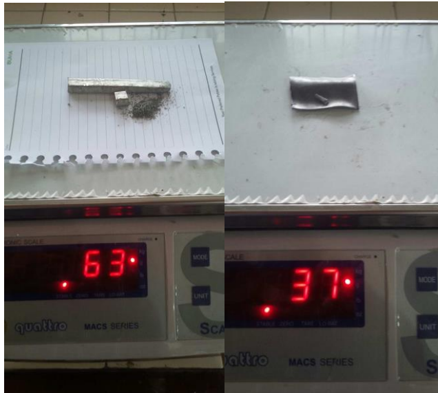
Gambar 3-2 Penimbangan komposisi timbal dan timah putih
