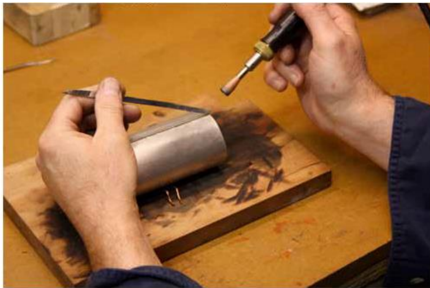
Gambar 2-1 Proses Penyolderan Pewter
