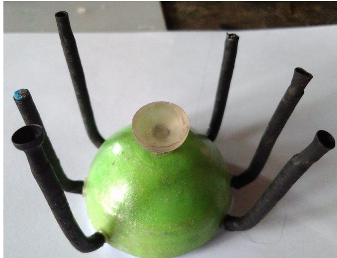
Gambar 3-14 Master cetakan yang sudah diberikan riser
