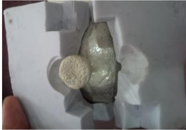
Gambar 3-16 Hasil penuangan pewter ke dalam cetakan silicone rubber
