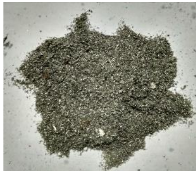
Gambar 3-5 Serbuk tenol ukuran mesh 120
