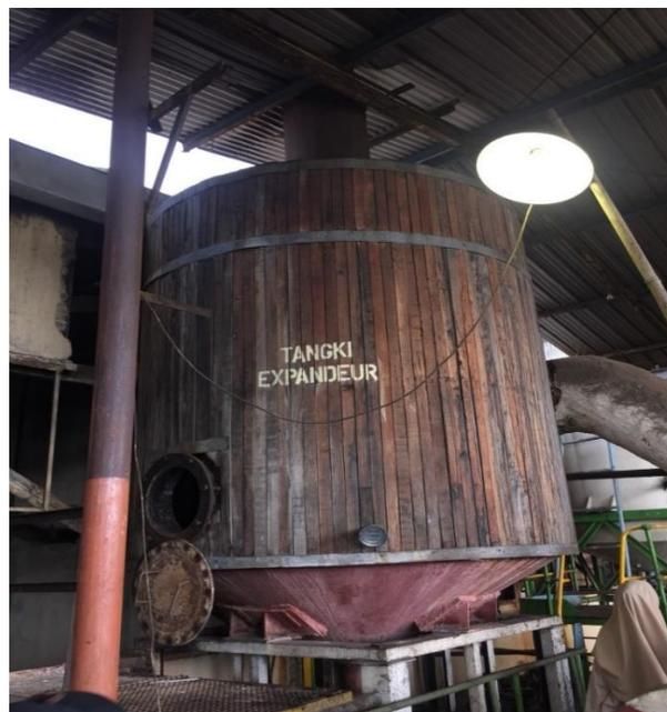
Gambar 4. 6 Mesin Pemurnian Tangki *Ekspandeur*
