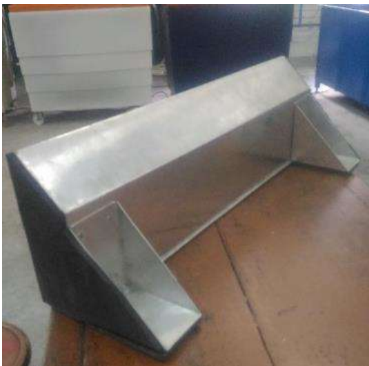
Gambar 8. Peluap V-Notch Lebar 1 m
