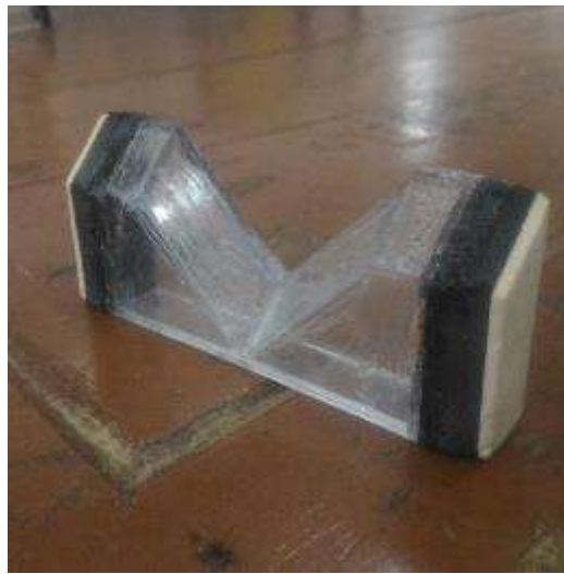
Gambar 4.11 Peluap V-Notch dengan Lebar 0,1 m
