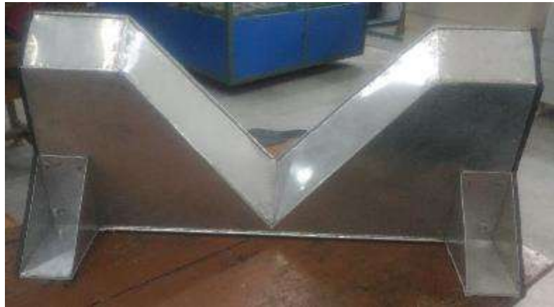
Gambar 4.13 Peluap V-Notch dengan Lebar 1 m
