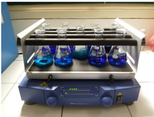
Dokumentasi 15 - Proses Adsorpsi Batch untuk Produk AFA-Suweg
