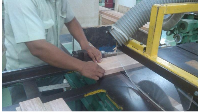
Gambar 4.5 pemasangan bahan dan setting ukuran Cleat
