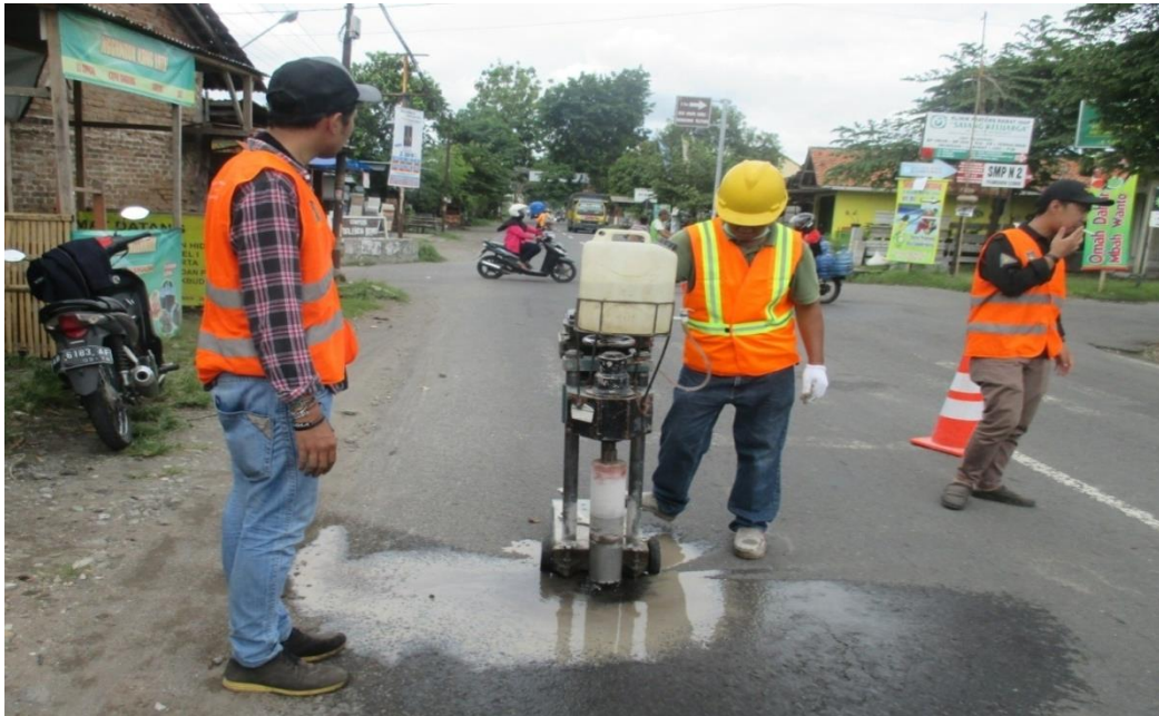
Gambar L – 7.3 Pengambilan Sampel Lapangan dengan Alat Coredrill
