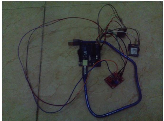
Setelah seluruh komponen terhubung dan program selesai dibuat maka alat siap memasuki tahap pengujian yang akan dilakukan pada kaca yang akan dipecahkan.
