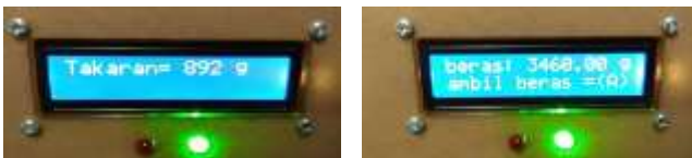
Gambar 9. Informasi takaran output beras, dan monitoring sisa beras pada rice box
