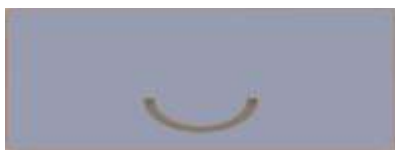
Gambar 4. Pelat valve beras dengan lubang parabola
