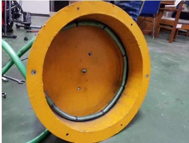
Gambar 4-9 area selang dan baling-baling pompa
