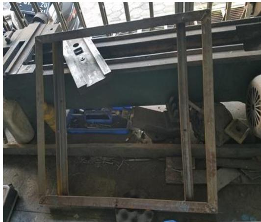
Gambar 3-11 kerangka pompa
