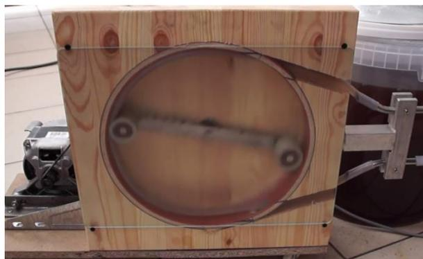
Gambar 2-7 Pompa Peristaltik
