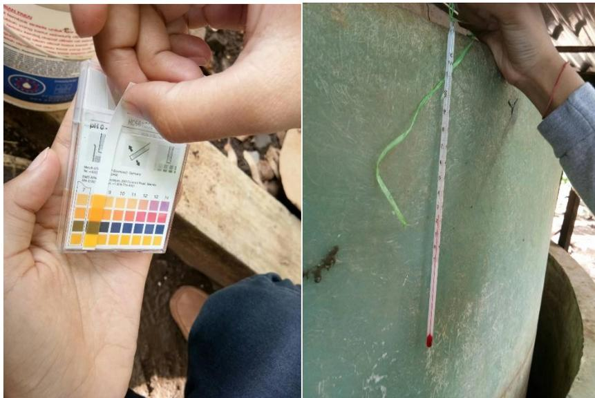
Gambar 3.3 Pengukuran pH dan temperatur di lapangan
