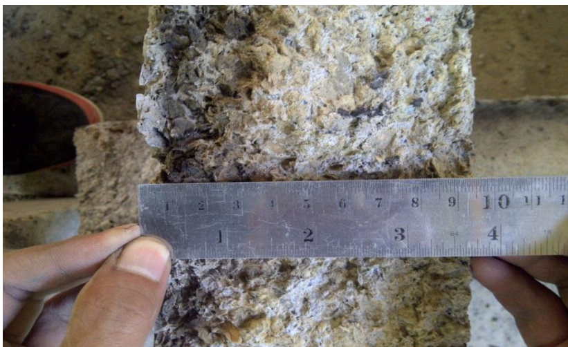
Gambar 5.21 Struktur Material Papercrete Pasca Bakar
